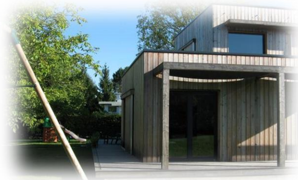
Ouvertures au sud + protections solaires (pergola, casquette)
